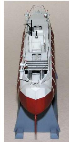
この深海艇は、スイスのオーギュスト・ピカール(Auguste Piccard)によって設計され、1953年にイタリアのナポリで建造されました。この船体の特徴的構造は、空気ではなくガソリンを浮力として使用しているところでしょう。耐圧性能の関係から比重の軽い液体を選択したものと思われます。そのため、通常の潜水艦のように沈降・浮上を、空気を貯めるバラストタンクで行うことができないため、沈降の際に錘として使う鉄球を放出することで浮上する構造となっていました。模型写真を見ていただきたいのですが、居住空間となる中央の耐圧球の前後に配置されたシリンダ形状のものが、鉄球を入れたサイロです。この深海艇は、1958年にアメリカ海軍に買い上げられ、1960年にはジャック・ピカール(オーギュストの息子)と米国海軍中尉との2名で、マリアナ海溝において10,916mの潜水記録を打ち立てました。
