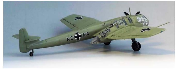
本機は、日本から祖国に戻ったリヒャルト・フォークト博士が設計し、1938年に原型が初飛行したドイツ空軍の偵察機です。実際に製作された非対称航空機という点では、右に出るものはない機体でしょう。「ネズ爺&ハテナンの特許探偵団 vol.17」でも取り上げましたが、プロペラのトルクを長い右翼とゴンドラで相殺させるという意図がありました。そもそもプロペラが一方向に回転する以上、プロペラ単発機ではプロペラトルクによる駆動力の偏りは避けられず、一見左右対称に見える通常の飛行機でも、トリムタブを使う、垂直尾翼を傾ける等、何らかの対応を取っていましたが、この機が採用した解決策は、エンジンナセルと操縦席のゴンドラを並列させるという大胆なレイアウトでした。偵察機ということで、視界を確保するという目的に合致するという僥倖もあって、一旦は採用となりましたが、結局、単発機というレギュレーション違反の双発偵察機、Fw187に敗れて、大量生産はされませんでした。試作機5機を含めて、全20機の生産に終わったようです。
