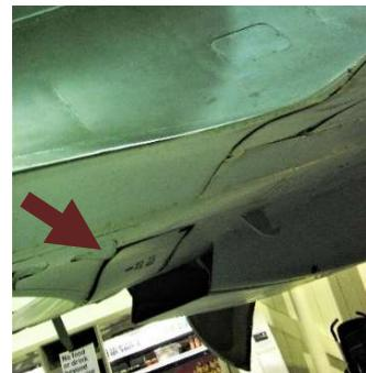
本機は、1936年に製作された、英國スーパーマリン社の戦闘機です。形からわかるように、スピットファイア戦闘機のプロトタイプです。前回(12)で説明したように、前作 Type224 試作戦闘機で失敗したレジナルド・ミッセルが橈円翼を使って設計を一新した美しい戦闘機です。1938年に正式採用されたスピットファイアは、ドイツ空軍から英國を守った1940年の「バトルオブブリテン」において奮戦し、救国の戦闘機となりました。さて、ミッセルは前作で採用し、上手くいかなかった逆ガル形状を、この機体では目立たない部位に使ってています。それは主翼の胴体付根部分で、主翼後縁部分は一度、下方に下げられて、翼端に向けて再び持ち上がっています。実機写真も掲載しますが、スピットファイアは特徴的な橈円翼ばかりに目が行ってしまいますが、こういった繊細な形状が同機の美しさを形作っています。
