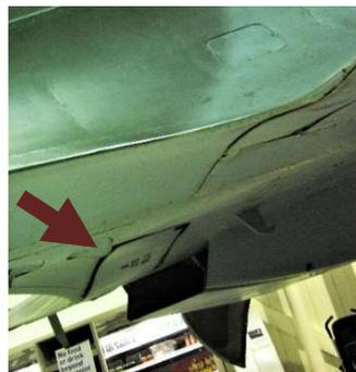
本機は、1936年に製作された、英国スーパーマリン社の戦闘機です。形からわかるように、スピットファイア戦闘機のプロトタイプです。前回(12)で説明したように、前作 Type224 試作戦闘機で失敗したレジナルド・ミッチェルが楕円翼を使って設計を一新した美しい戦闘機です。1938年に正式採用されたスピットファイアは、ドイツ空軍から英国を守った1940年の「バトルオブブリテン」において奮戦し、救国の戦闘機となりました。さて、ミッチェルは前作で採用し、上手くいかなかった逆ガル形状を、この機体では目立たない部位に使っています。それは主翼の胴体付根部分で、主翼後縁部分は一度、下方に下げられて、翼端に向けて再び持ち上がっています。実機写真も掲載しますが、スプリットフラップが主翼形状に沿って曲がっていることがわかります。スピットファイアは特徴的な楕円翼ばかりに目が行ってしまいがちですが、こういった繊細な形状が同機の美しさを形作っています。
