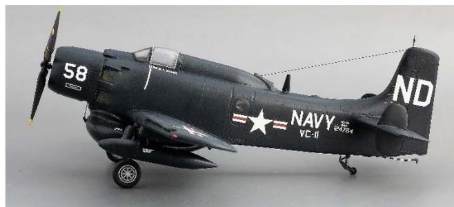
本機 AD-4W は、ダグラスの AD スカイレーダー攻撃機から派生した艦載機です。お腹に大きなレドームを有しますが、このレーダーは海面に向けて照射され、潜水艦の潜望鏡やシュノーケルを探知して、これを発見する哨戒機でした。朝鮮戦争時代に使用されています。元の AD スカイレーダー自体、極めて優秀な攻撃機でしたが、さすがにこれだけ大きなコブをお腹に搭載して気流が乱れると、失速特性が悪くなったのでしょうか、本家にはない、固定スラットが主翼前縁に取り付けられ、水平尾翼には垂直安定板が増設されています。AD スカイレーダーは、第二次世界大戦直後に就役し、ベトナム戦争まで使用された息の長い機体で、多様なバリエーションが作成されましたが、この哨戒機バージョンはその中での特異な外観を有していました。
