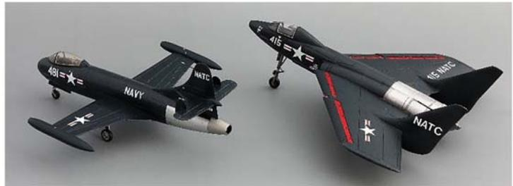
本機は、名機 F4U コルセアを送り出したチャンスポート社が初めて作ったジェット機です。1949年に初飛行しています。しかし、アンダーパワーで期待通りの性能を発揮できなかったため、量産機は30機に留まりました。本連載第7回の F4U-5N の際にも言及しましたが、とにかく F4U の主翼後方に配置したコクピット配置は艦上機としては欠点だったようで、チャンスポート社は XF5U 以降、コクピットを極端に機体前方に配置します。この機体も例外ではなく、主翼前方に長く伸びた機首先端にコクピットを置いており、まるで雁が首を伸ばして飛ぶ姿を連想させるデザインでした。翼端の増槽配置は翼端の渦抵抗を低減させるための配置で、当時、最新の知見に基づく外形でもありました。
