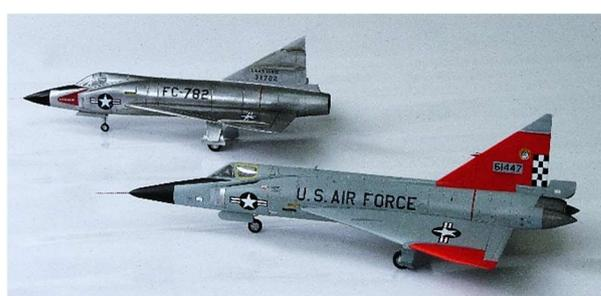
本機は、1953年に初飛行したアメリカ空軍の迎撃戦闘機です。フランスのミラージュのようなデルタ翼を有していました。「ネズ爺&ハテニヤンの特許探偵団 vol.5」で取り上げたように、この機体は、機体の形状で性能を向上させられるという「エアールール」の有効性を、身をもって体現した機体でもあります。その試作機 YF-102 と比べると、基本的な構成は同じでも、全長が長くなり、また胴体部分がまるでコカ・コーラのビンのようにくびれていて、同機はこの形状変更によって音速を超えることができました。かつては、米国空軍が使っていた板付空港、いまの福岡空港にも駐屯していたこともあり、空港のターミナルビルの壁面にもこの機体が描かれているようです。なお、コンベア社(Convair)の名前は、Consolidated Vultee Aircraft Corporation から来ており、同社はかつて大戦中に B-24 やカタリナ飛行艇を生産していた会社でもありました。
