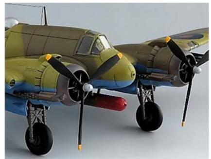
本機は、ブリストル社がボーフォート雷撃機と同時期に開発した戦闘雷撃機です。マルタ島の攻防戦など地中海等において、枢軸国の輸送船攻撃に使用されました。ボーフォート爆撃機と主翼を共通にして開発されただけあって、やはり戦闘機としては大型の機体です。ボーフォートの中翼を改め、低翼としたためか、エンジンナセルが主翼の上方に張り出すように移動しています。そのため、水平尾翼に当たるプロペラ後流が好ましくない影響を与えたのでしょう、水平尾翼の先端を斜め上に持ち上げ、バンザイさせてV字型にしています。この水平尾翼、本来ならあまりカッコよいものではありませんが不思議と良い味を出しています。埃っぽい飛行場をタキシングしている本機のカラー写真が残っていますが、ミドルストーン/ダークアースの茶色系の迷彩が、その風景にとっても似合ってます。
