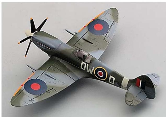
(マーリンエンジン搭載の Mk. IX と : 機首のイメージが大きく異なります。プロペラの回転方向が逆になっていることにも注目↓)
