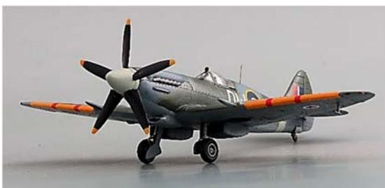
本機 Mk.XIV(14)型は、マーリンエンジンに代えてグリフォンエンジンを搭載したスピットファイアの最初の型です。形式的には、米国製パッカードマーリンを搭載した Mk.XVI(16)を除いて、これ以降の型は Mk.22/24 まで全てグリフォンエンジン搭載となります。このグリフォンエンジンは、マーリンでやや上にあったプロペラ回転軸が下がり、胴体の中心に位置しています。それに伴いスピナーが大型化され、5枚になったプロペラとともに、マーリン・スピットファイアと比べると大きく機首の印象が変わります。個人的にはガンダムからガンダム Mk-II になったという感じで、好きなスピットファイアです。なお、グリフォンエンジン(パイロットから見て反時計回り)はマーリンエンジン(同時計回り)と回転方向が逆のため、マーリン・スピットでの空戦に慣れていたパイロットには、相当な違和感があったのではないかと想像します。
