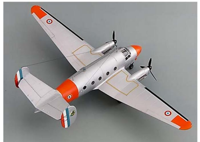
1947年に初飛行した、ダッソー社が作ったフランス空軍の操縦訓練機(コクピット天井に、キャノピーを覆うカーテンが見えます)及び地上攻撃機です。終戦から2年しか経っていないのに、前脚式で、胴体断面が円形という時代を先取りしたフォルムを採用したフランス人の感覚に驚かされます。エンジンはアルグス AS410(ルノー12S)という、大戦中も Fw189 偵察機などに使われた 600 馬力の空冷のインラインエンジン(空冷で直列は珍しい)を使用しており、プロペラ下のエアインテイクから、倒立したエンジンシリンダが覗くことになります。胴体が円形断面とはいいいながら、この非力なエンジンではキャビンの与圧はされていなかったと思います。余談ながら、胴体上下の鉤型アンテナ(矢印)は多分航法用だと思うのですが、「帰ってきたウルトラマン」に登場するブラックキングの角そっくりwです。この角、本アンテナと同じく実はナックル星人が操るための受信装置だったと思うと楽しいですw。
